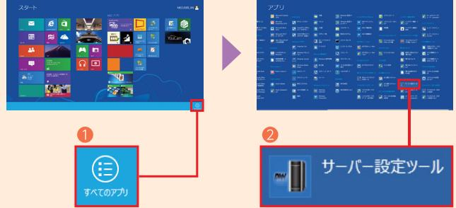
スタート画面を表示します。タイトルのないところにマウスポインタを移動し、マウスを右クリックします。画面右下に表示された①[すべてのアプリ]をクリックします。アプリが表示されたら、マウスピントを画面右端に移動し、画面をスクロールさせます。ホームネットワーク欄にある②[サーバー設定ツール]をクリックしてアプリを起動します。
