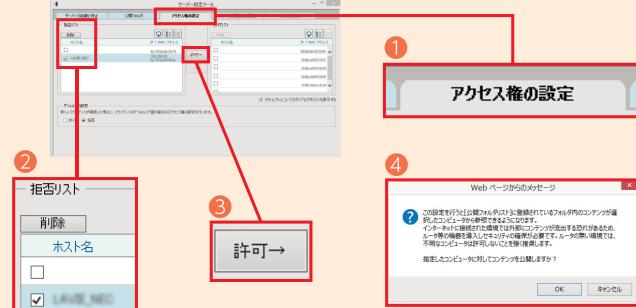
サーバー設定ツールが起動したら①[アクセス権の設定]タブをクリックします。拒否リスト欄に表示された子機(TVなしパソコン)に②チェックマークを付け、③[許可→]をクリックします。子機が許可リスト欄に移動します。「Webページからのメッセージ」画面が表示されたら④[OK]をクリックします。
