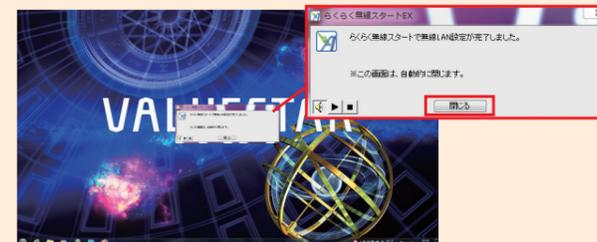
パソコンに「らくらく無線スタートで無線LAN設定が完了しました。」と表示されたら、Atermとの接続は完了です。[閉じる]をクリックします。
