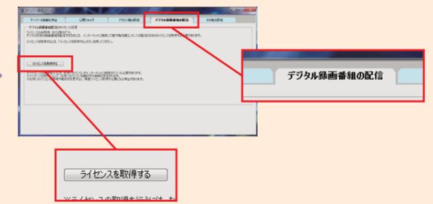
[デジタル録画番組の配信]タブをクリックして[ライセンスを取得する]をクリックします。[DTCP-IP機能の有効化]画面が表示されるので[OK]をクリックし、サーバー設定ツールを閉じます。
