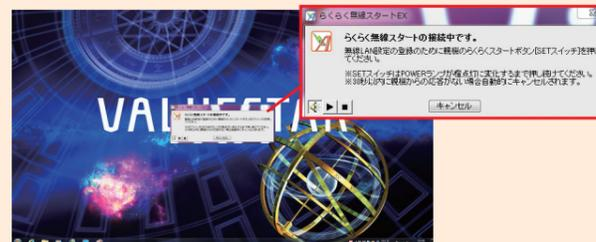
パソコンに「らくらく無線スタートの接続中です。」と表示されたら、再度、Atermの[らくらくスタートボタン]を押します。今度は、AtermのPOWERランプが**オレンジに点灯**するまで押し続けてください。
