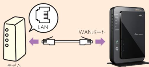
プロバイダとインターネット回線の契約をしている場合は、プロバイダ側で用意されているブロードバンドモデムとAtermを使用します。接続方法は、それぞれの取扱説明書を参照してください。
