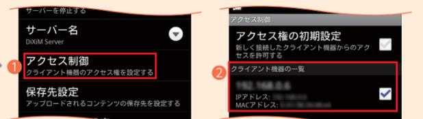
①[アクセス制御]をタップします。接続するパソコンのIPアドレスが②[クライアント機器の一覧]に表示されます。該当するIPアドレスにチェックをつけます(初回設定時のみ)。
