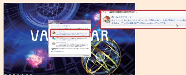
パソコンがLANに接続したら、自動的に[ネットワークの場所の設定]が表示されます。ここで「ホームネットワーク」を選択します。
